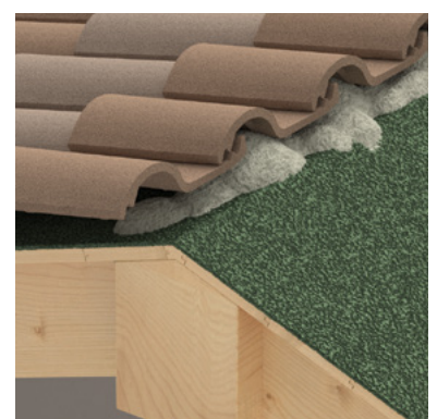
CASO 4 Posa diretta sull'estradosso del solaio e fissaggio a schiuma.
