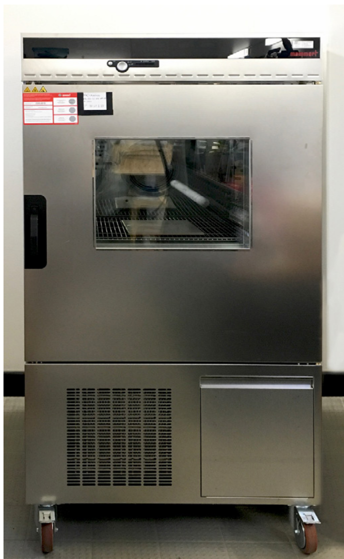
Camera climatica per la verifica dei ponti termici
